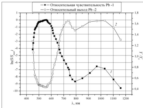
Рис.2. Спектр относительной фоточувствительности  $S/S_{max}$  и спектральная зависимость относительного выхода ионов свинца, рассчитанная по формуле (1).
