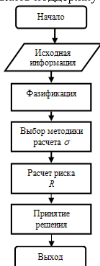
Блок-схема системы диагностики линейной части магистрального газопровода
