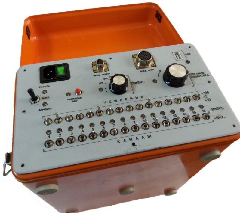
Рис. 1. Внешний вид цифрового геофизического регистратора
