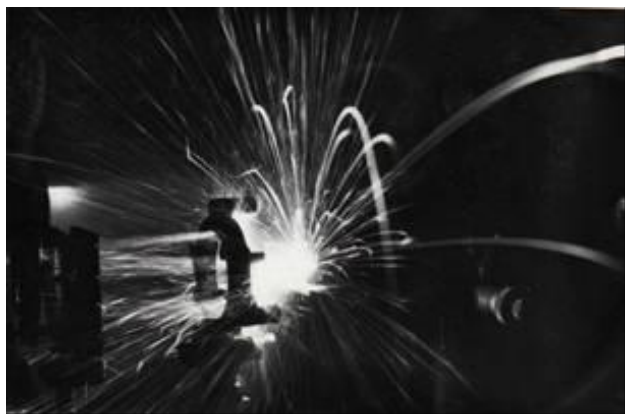
Опыты с первым рубиновым лазером: луч пробивает металл; плазма в воздухе.
