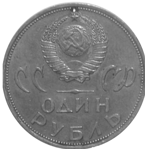
Опыты с первым рубиновым лазером: монета, пробитая лучом
