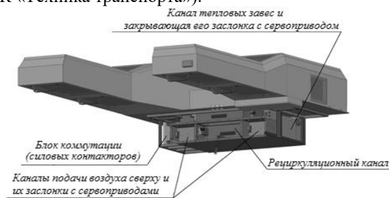
Рис. 1. Внешний вид моноблока со стороны каналов подачи воздуха в салон и рециркуляционного канала
