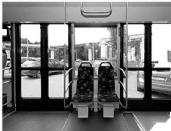
Рис. 5. Внешний вид отопителей салона в трамвайном вагоне 71-911
