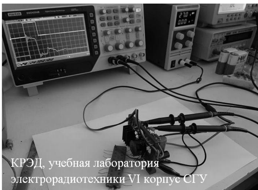
Рис.2. Экспериментальный макет коммутатора, выполненного на полевых транзисторах.
