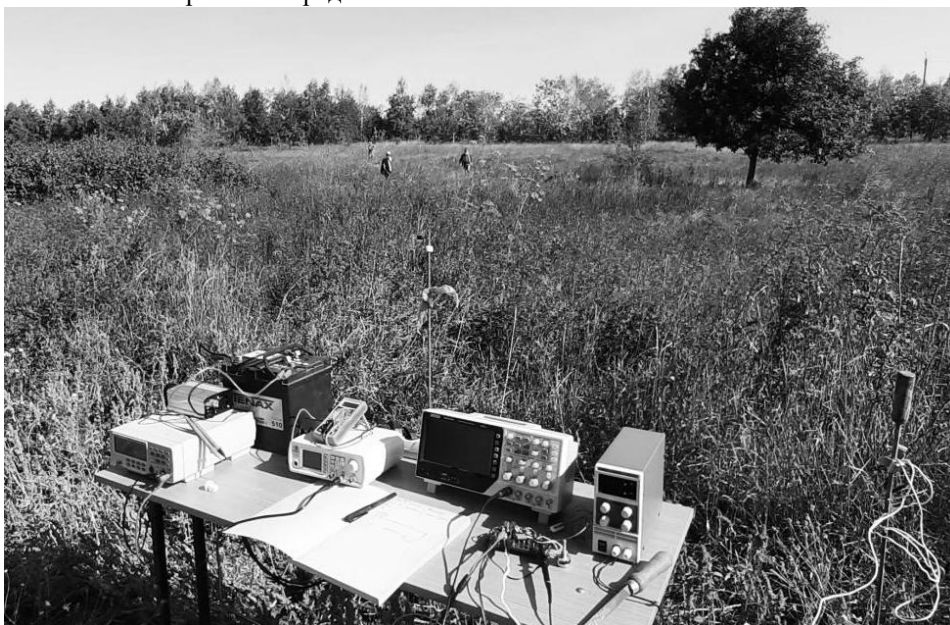
Рис.1. Проведение эксперимента по определению формирующих свойств однопроводной длинной линии.
