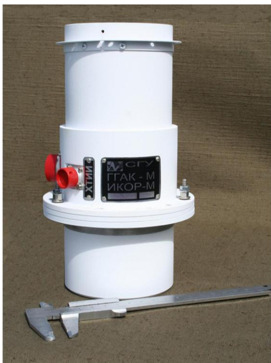
Измеритель коротковолновой отраженной радиации ИКОР-М для бортового гелиогеофизического аппаратного комплекса ГГак-М ИСЗ «Метеор-М»
