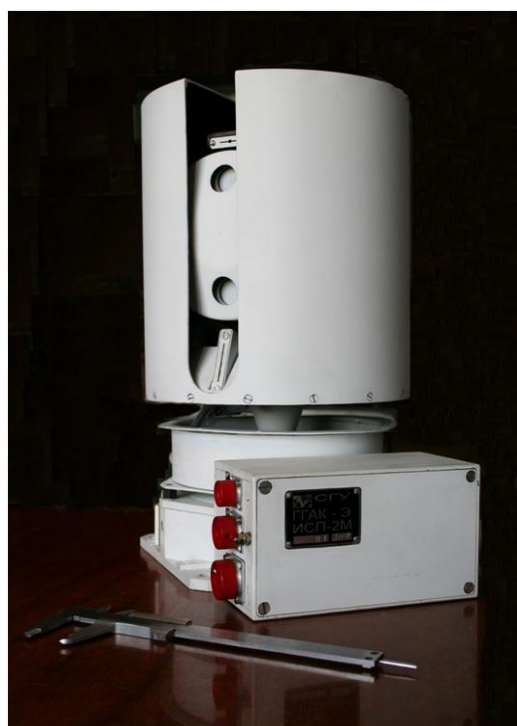
Измеритель солнечной постоянной ИСП-2М для бортового гелиогеофизического аппаратного комплекса ГГак-Э ИСЗ «Электро – Л»
