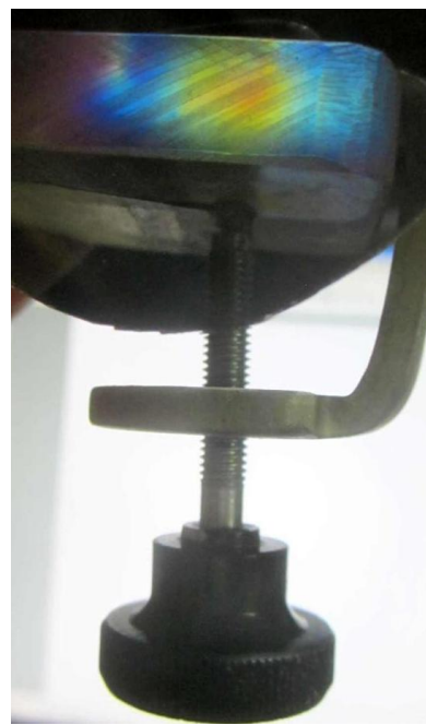
Рис. 3. Окрашивание напряженной пластины из оргстекла
