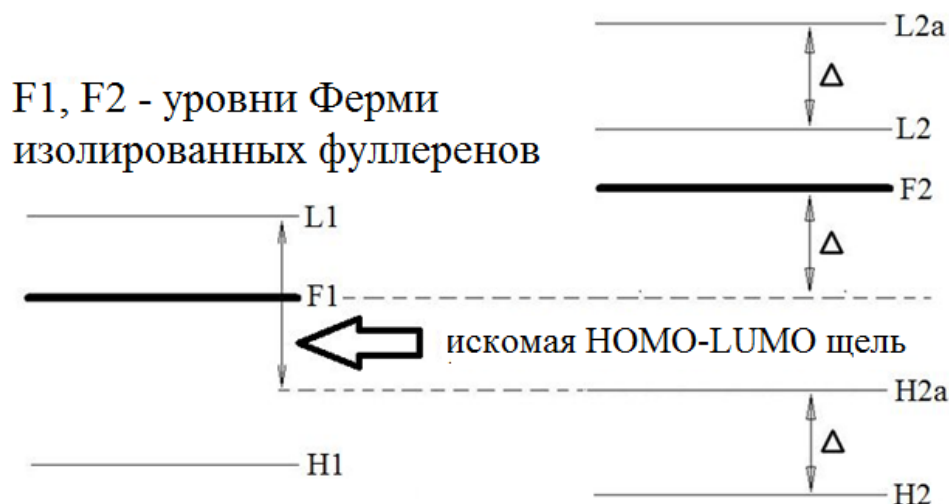
Рис. 2. Алгоритм вычисления энергетической щели бислойных фуллеренов как разницы между НОМО- и LUMO-уровнями.
