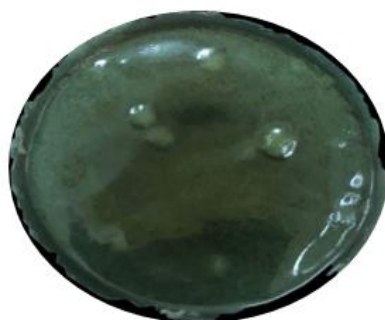
Рис. 3.6 Фотография исследуемой мембраны на основе [\text{Ag}(\text{Амох})_2]\text{ДМДСА} , модифицированной наноструктурированным полианилином ( C_{\text{зас}}=2\% ).
