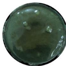
Рис. 3. Фотография исследуемой мембраны на основе [\text{Ag}(\text{Амох})_2]\text{ДМДСА} , модифицированной наноструктурированным полианилином ( C_{\text{эас}}=2\% )
