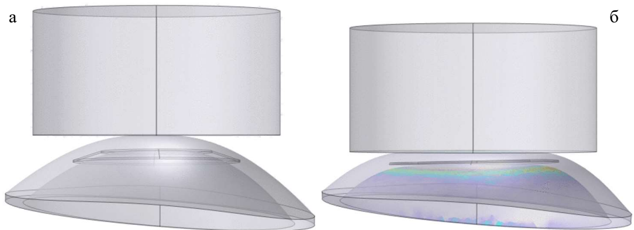
Рис. 5.5 — Модель аппланации роговицы жестким штампом (аппланационной линзой): а — начальное положение; б — аппланированное состояние
